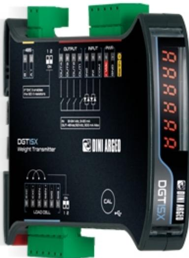
Trasmettitore di peso specifico, ideale per sistemi di pesatura dinamica e/o robotica ad alta velocità. Grazie al suo algoritmo e alla velocità di conversione, calcola il peso di una confezione che scorre su un nastro di pesatura e memorizza i dati in una memoria leggibile dal bus di campo. Progettato per una produttività di oltre 200 pz./min.
